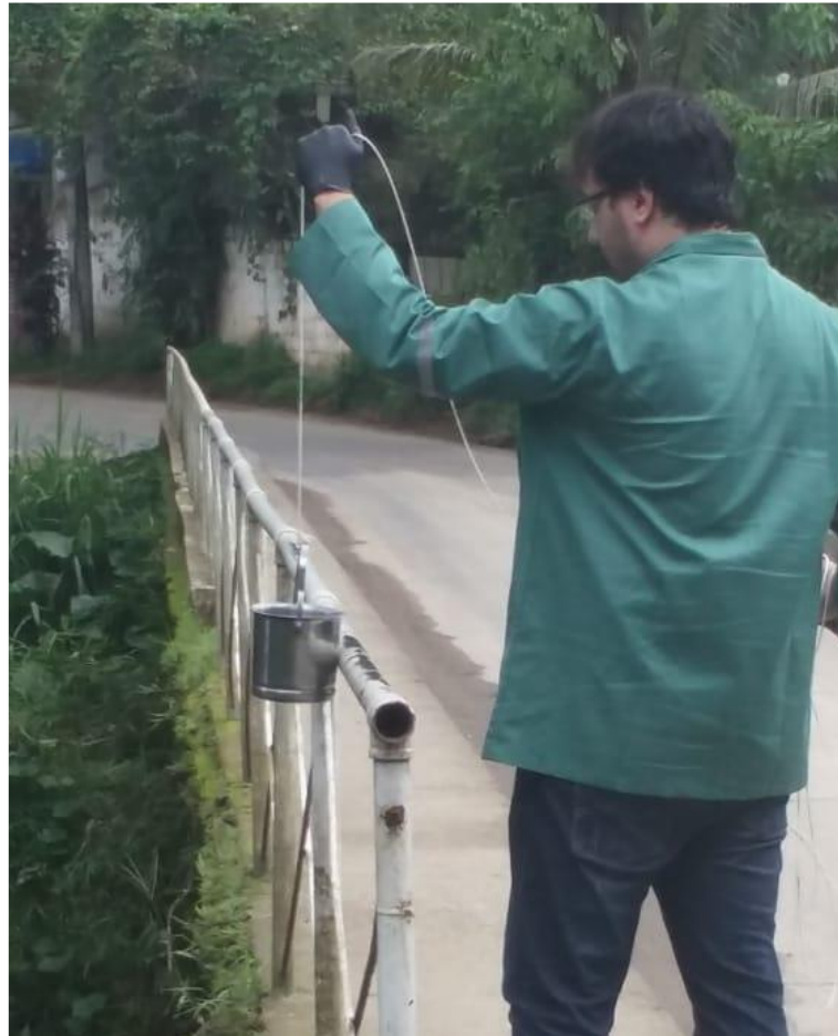
Figura 4.6 - Coleta de amostra no Rio Perequê-Açú montante
