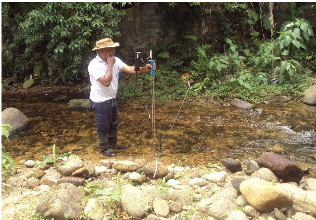
Figura 4.3 - Medição de vazão com Flowtracker no Rio Campo Alegre
